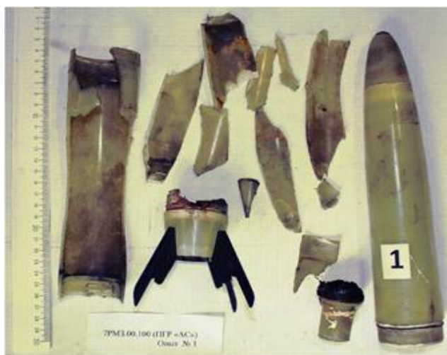
ნახ. 23. დაქუცმაცების შემდეგ სეტყვის საწინააღმდეგო რაკეტა „Ac“-ის კორპუსის ფრაგმენტები
