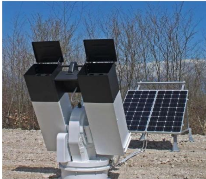
ნახ. 58. საქართველოში შემუშავებული და დამზადებული ავტომატიზირებული სეტყვასაწინააღმდეგო რაკეტების გამშვები დანადგარი სდ-26
