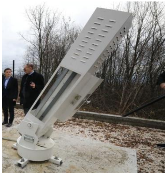
ნახ. 57. სერბული ავტომატიზირებული სეტყვასაწინააღმდეგო სისტემის გამშვები დანადგარი
