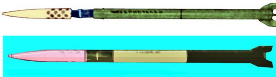
ნახ. 12. სეტყვის საწინააღმდეგო რაკეტები „Кристалл“ (ზემოთ) და „Алазань“ (ქვემოთ)
