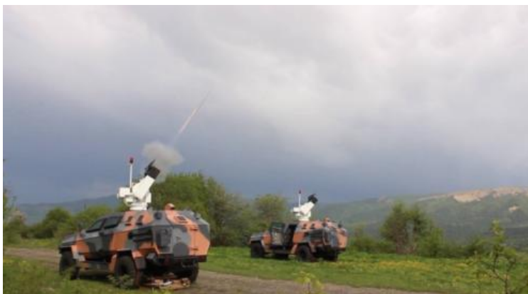
ნახ. 82. სამეცნიერო-ტექნიკურ ცენტრ „დელტა“-ს (საქართველო) წარმოების მობილური ავტომატური გამშვები „სდ-26“ ტიპის დანადგარის დროებითი ვარიანტი დისტანციური მართვით, სეტყვის საწინააღმდეგო რაკეტების გასაშვებად
