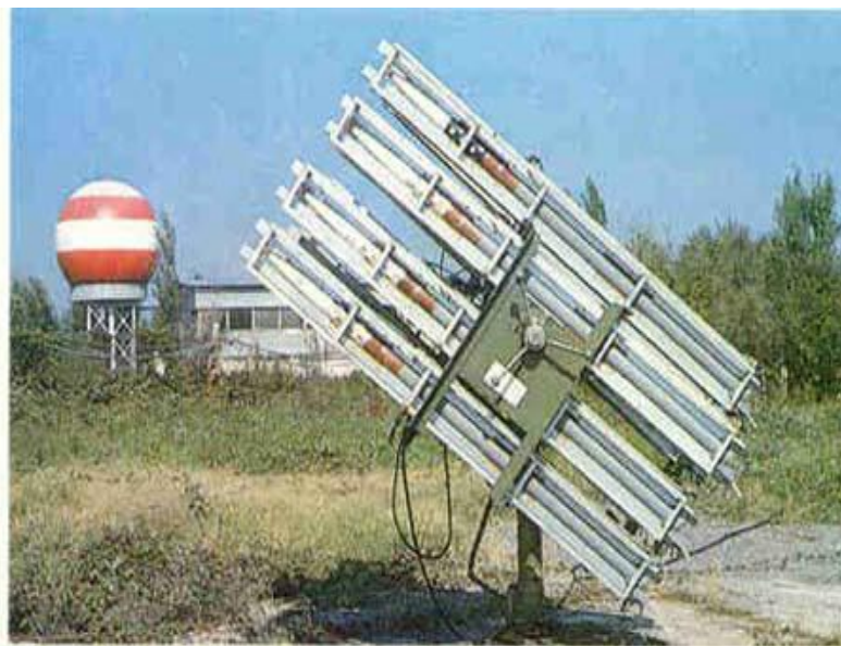
ნახ. 14. სეტყვის საწინააღმდეგო სარაკეტო კომპლექსი „Кристалл“ პოზიციაზე
