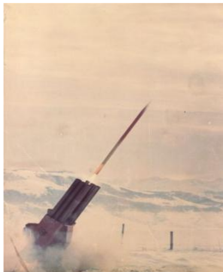
ნახ. 10. სეტყვის საწინააღმდეგო რაკეტა „He60“-ს გამშვები დანადგარი (მარცხენი) და – სტარტის მომენტი (მარჯვნივ)
