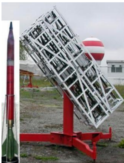
ნახ. 7. „Облако“ (სეტყვის საწინააღმდეგო რაკეტა). მარცხნივ – საერთო ხედი და გამშვები დანადგარი, მარჯვნივ – სტარტის მომენტი
