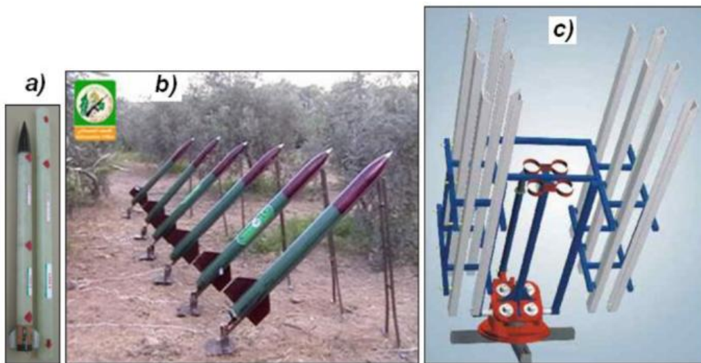
ნახ. 3. ბულგარული რაკეტა „Loza-6“ გამშვები კონტეინერით (a), სეტყვის საწინააღმდეგო მოწყობილობა „Lazur“ (b) და კომბინირებული დანადგარი მათ გასაშვებად (c).
