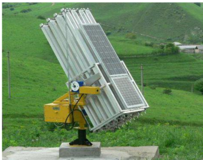
ნახ. 56. ავტომატიზირებული სეტყვასაწინააღმდეგო სარაკეტო გამშვები დანადგარი „ელია-2“
