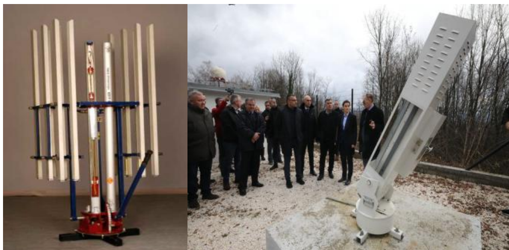
ნახ. 65. უმარტივესი გამშვები დანადგარი სეტყვის საწინააღმდეგო რაკეტებისთვის „KRUSIK'S ANTI-HAIL SYSTEM (KPGS)“ (მარცხნივ) და სერბული წარმოების ავტომატური გამშვები დანადგარი სეტყვის საწინააღმდეგო რაკეტის გასაშვებად (მარჯვნივ) [125]
