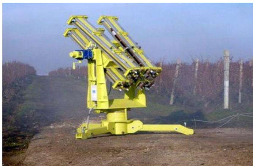
ნახ. 60. «ILRAG» სეტყვის საწინააღმდეგო რაკეტების გამშვები დანადგარი «LARMA1»
