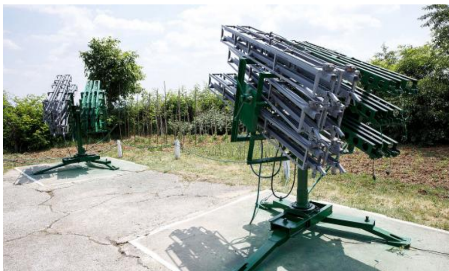
ნახ. 62. უნივერსალური გამშვები დანადგარი 82,5 მმ კალიბრის («Алазань-6» – მარცხენა ნაწილი) რაკეტების და 60 მმ კონტეინერებისთვის («Люза-2», «Люза-7» – მარჯვენა ნაწილი) – «ТКБ-040» ტიპის მოდერნიზირებული დანადგარი
