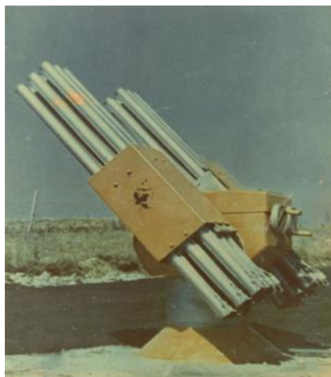
ნახ. 10. სეტყვის საწინააღმდეგო რაკეტა „He60“-ს გამშვები დანადგარი (მარცხენი) და – სტარტის მომენტი (მარჯვნივ)
