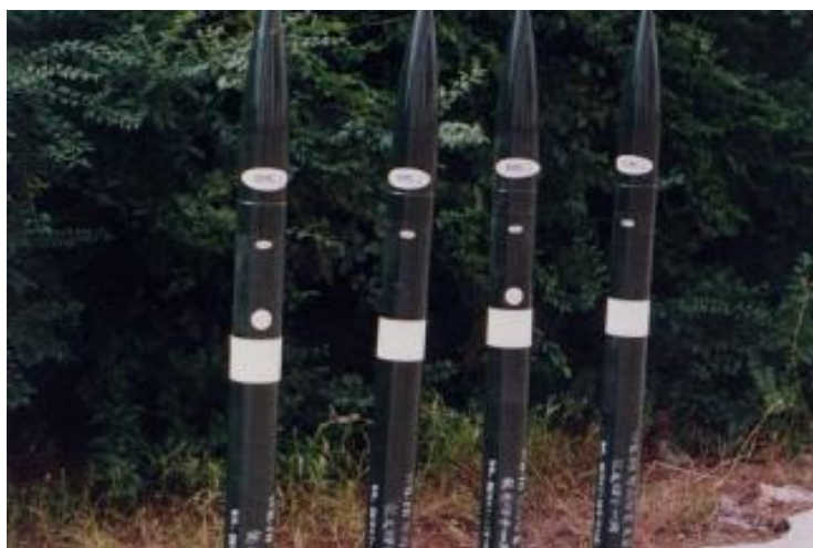
ნახ. 74. „WR-98“ ტიპის რაკეტა ნალექების რაოდენობის გასაზრდელად და სეტყვის საწინააღმდეგოდ [134]
