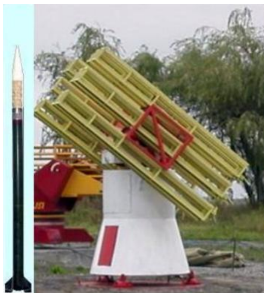
ნახ. 13. სეტყვის საწინააღმდეგო სარაკეტო კომპლექსი „Кристалл“
