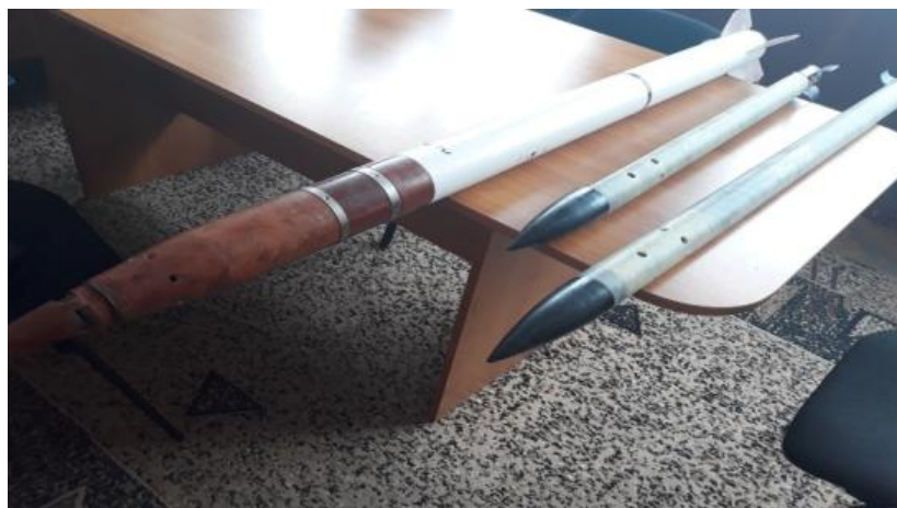
ნახ. 61. მარცხნიდან მარჯვნივ: სამი ტიპის რაკეტა, რომლებსაც სეტყვის საწინააღმდეგო სამუშაოების დროს კომპლექსურად გამოიყენებენ მოლდოვაში: «Алазань-6» (მარცხნივ), «Люза-3» (მარჯვნივ) და «Люза-2» (შუაში)
