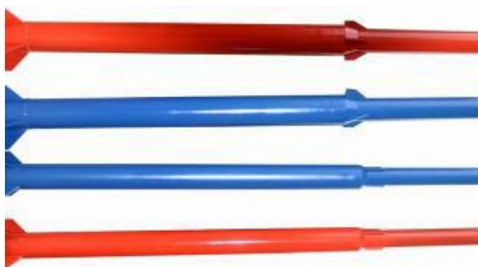
ნახ. 78. „WR-98“ ტიპის რაკეტების საბრძოლო ელემენტები ნალექების მოსაყვანად და სეტყვასთან ბრძოლისათვის
