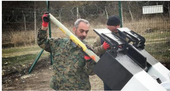
ნახ. 81. სამეცნიერო-ტექნიკურ ცენტრ „დელტა“-ს (საქართველო) წარმოების თანამედროვე სტაციონარული ავტომატური გამშვები „სდ-26“ ტიპის დანადგარი დისტანციური მართვით „SK-6“, „Trayal D 6B“ და „Loza-2“ ტიპის სეტყვის საწინააღმდეგო რაკეტების გასაშვებად [105, 137]
